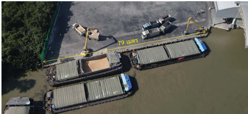
รูปที่ 4.3.2-5 ลักษณะการจอดเทียบท่าของเรือขนาดไม่เกิน 500 ตันกรอส เพื่อขนถ่ายสินค้า
